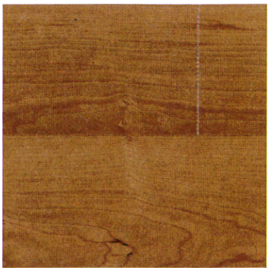
節 枝が成長した幹に巻き込まれた部分
