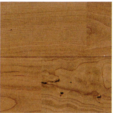
ガムポケット 成長の過程で、細胞の隙間に樹脂が溜まってできる点や筋状の変色
